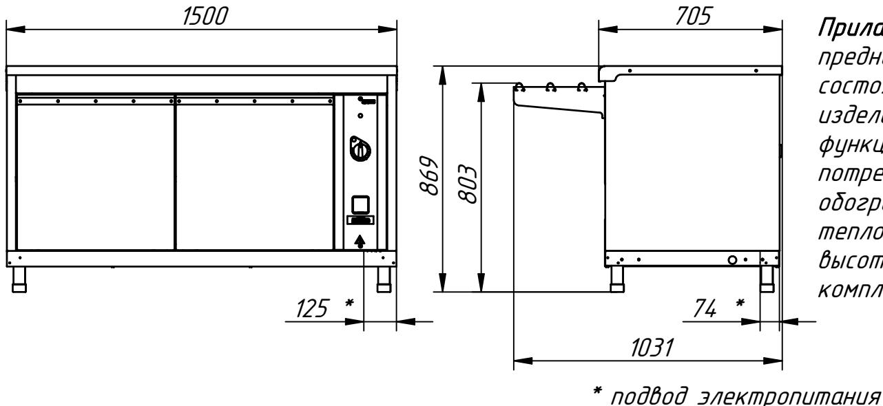
Прилавок тепловой электрический кухонный типа ПВТ предназначен для кратковременного хранения в теплом состоянии мелкоштучных хлебобулочных и кондитерских изделий и пищевых продуктов на тарелках, функциональных емкостях, подносах и раздачи их потребителю. Столешница и внутренний объем прилавка обогревается теплым воздушным потоком, создаваемый тепловентилятором. Прилавок имеет регулируемые по высоте ножки. Направляющие для подносов входят в комплект поставки.
